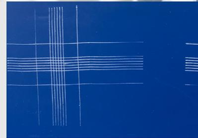
Rhenoplast KP 1+. Prüfung nach DIN EN 478. Fläche wird lackiert. Nach Trocknung auf 150 °C erhitzt und dann verdreht. Abkühlung im Eiswasser. Ergebnis: keine Risse, keine Haftungsprobleme.
